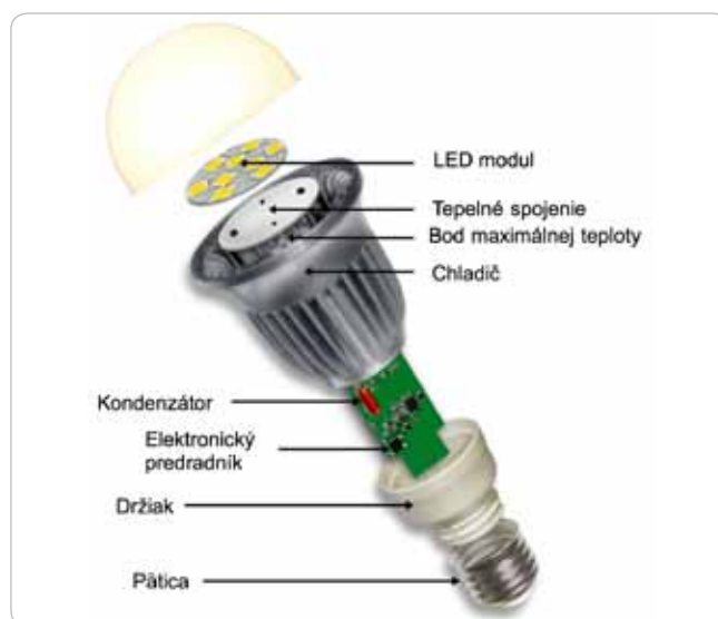
Obr. 6 Schéma konštrukcie LED „retrofitu“
