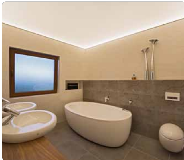
Obr. 2 Svetelný strop na celú miestnosť nám zabezpečí okrem vysokej intenzity aj dokonalú rovnomernosť až r = 0,8 . Takéto osvetlenie sa môže považovať za ideálne a zdravé osvetlenie priestoru – osvetlenie ako z oblohy ( www.svetelnestropy.sk ).
