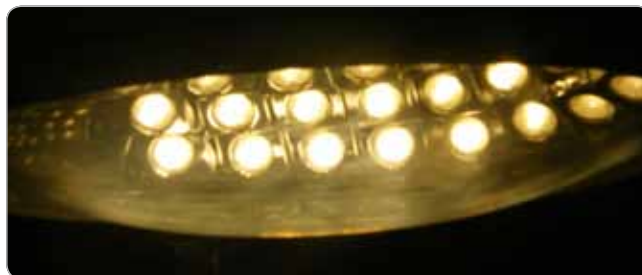
Obr. Závojevý jas na krycom vypuklom skle po dvoch rokoch prevádzky, zaparené prostredie
